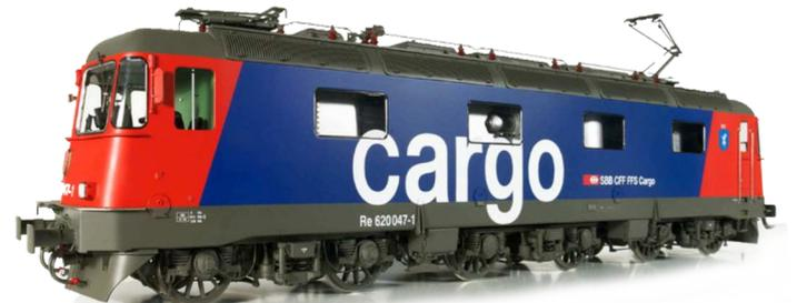
Die noch im Einsatz stehenden verkehren meist in Doppeltraktion mit einer Re 4/4 II oder Re 4/4 III, in Ausnahmefällen auch mit einer zweiten Re 6/6. Ein solches Gespann leistet dann 21'200 PS. Das neue blau/rote Cargo Design erhalten die Lokomotiven bei fälligen Revision. Dann erhalten sie auch die neue Bezeichnung als Baureihe Re 620.
