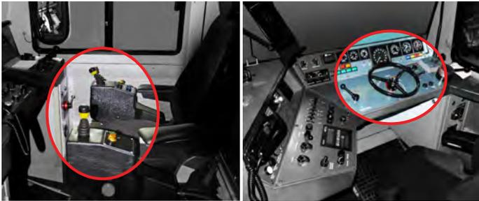
*Die beiden Abbildungen zeigen die grundsätzlich verschiedenen Bedienungsarten für die Loksteuerung. Links die im Lokführersitz integrierten Sidestick Regler, rechts das konventionelle Handrad.*
