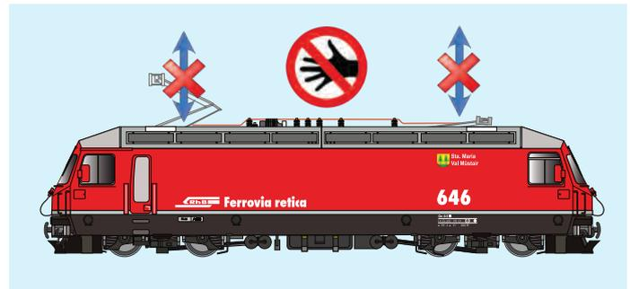
**⚠** Das Modell verfügt über motorisch angetriebene Stromabnehmer, die nicht von Hand gehoben werden dürfen. Die Stellung des Stromabnehmers muss ebenfalls vor der ersten Fahrt auf Profilhängigkeit (Tunnels, Brücken usw. ) geprüft werden. Beschädigungen infolge nicht Beachtung der Profilhängigkeit sind von der Garantie ausgeschlossen.
